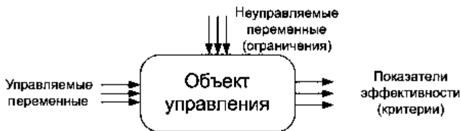
Рис. 2.1. Схема построения математической модели для объектов управления («черный ящик»)
